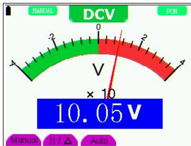
Obr. 33: Nastavení Automatického nebo Manuálního rozsahu Upozornění: Kondenzátory neměřte v manuálním rozsahu.
