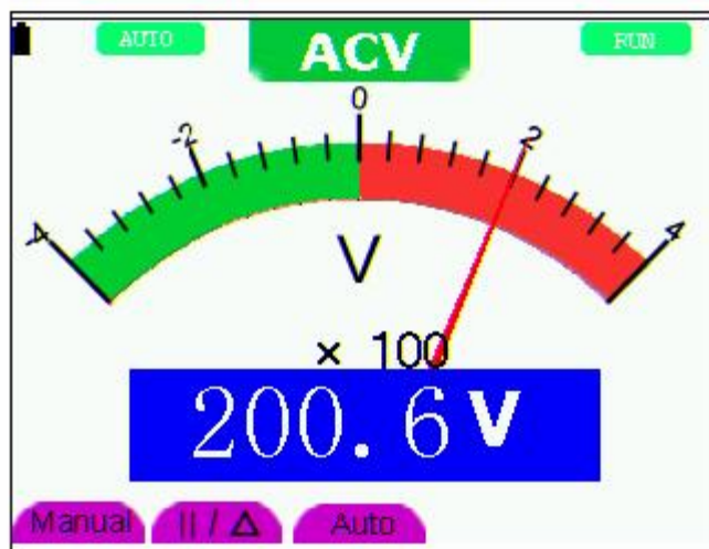
Obr. 26: Měření AC Napětí
