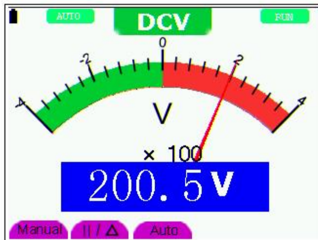
Obr. 25: Měření DC Napětí
