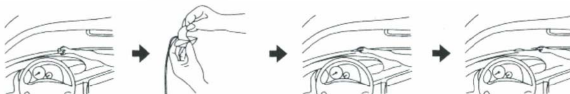
Obr. 6 - Umístění a přilepení displeje. Nalezněte vhodnou plochu, tu očistěte. Z displeje odstraňte krycí papír, čímž odkryjete lepicí plochu. Displej pevně přitiskněte na vybranou pozici. Poté umístěte přírodní vodič dle Vašich požadavků (vhodné je skrýt jej pod palubní desku).
