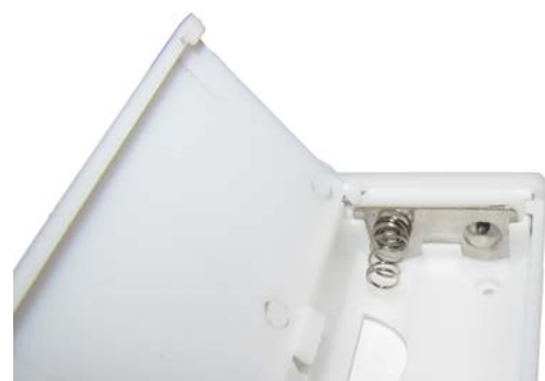
Obr. 6 umístění propojovacího dílu pro baterie
